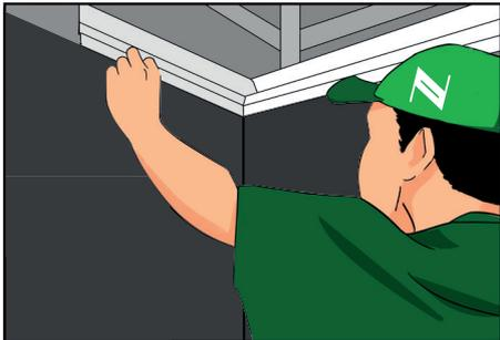
**04** O comprimento do forro deve ser ajustado de acordo com o ambiente de instalação. Recomenda-se deixar por segurança um espaçamento de 5mm de folga em cada um dos lados, para que caso ocorra uma dilatação térmica, o forro não sofra nenhum tipo de alteração.
